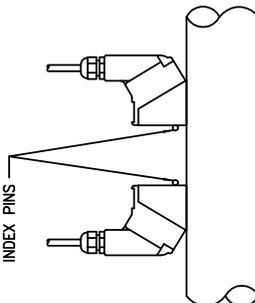
ORIENTATION OF PROPERLY INSTALLED TRANSDUCERS IN REFLECT MODE OPERATION
